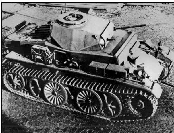
▲ Panzerkampfwagen I Ausf C měl věž podobnou jako Panzerkampfwagen II, s vnější maskou a velitelskou věžičkou. Pohonnou jednotkou byl motor Maybach HL 45 P a vozidlo dosahovalo maximální rychlosti přes 79 km/h. V přední části odkládacích schránek na pravém blatniku je soustava tří vrhačů dýmotvorných granátů N.b.K. Velká pojezdová kola byla na torzních tyčích. Použité pásy byly typu KGS 62/290/90. Patton Museum
