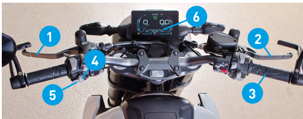
1 - spojka / 2 - brzda / 3 - plyn / 4 - směrovky / 5 - klakson / 6 - přístroje
