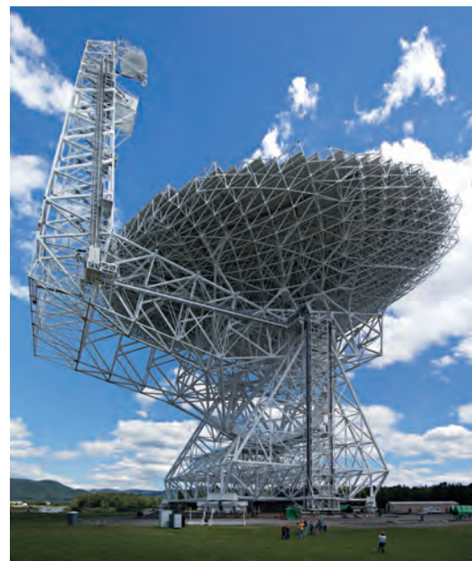
K měření vzdáleností objektů ve Sluneční soustavě se používají radioteleskopy. Měří se časový interval mezi vysláním radiové vlny a jejím návratem. Z toho se vypočítá vzdálenost s přesností na metry
