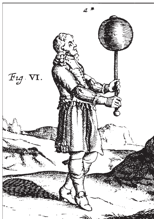
Obr. 2.8. Pokus Otto von Guericka, jímž předváděl, že „zelektrovaná“ sírová koule odpuzuje lehká těliska. Nabitá sírová koule tělisko nejprve přitáhne, přetáhne mu část svého náboje a pak jej jako stejně nabitě odpuzuje.
