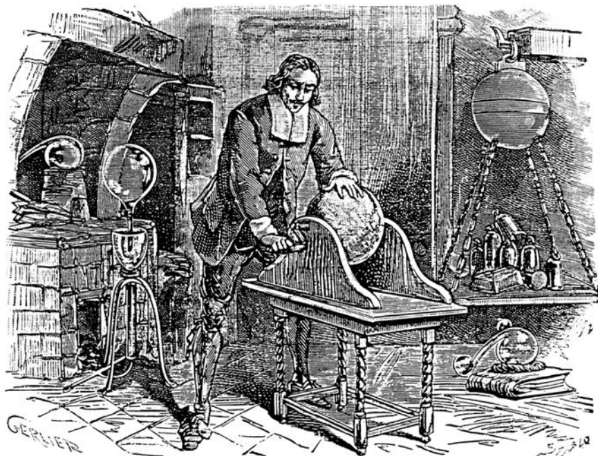
Obr. 2.7. Třecí elektrika, kterou sestrojil Otto von Guericke.
