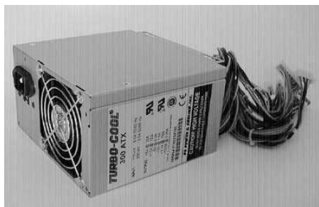
Obrázek 2.3 Napájecí zdroj PC s konektory
